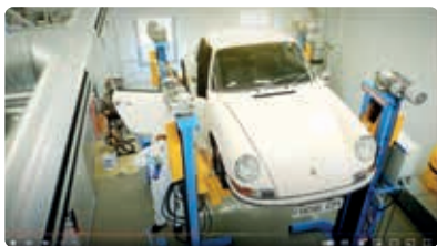
Hohlraumkonservierung in der Praxis – ANTICORIT CPX®
